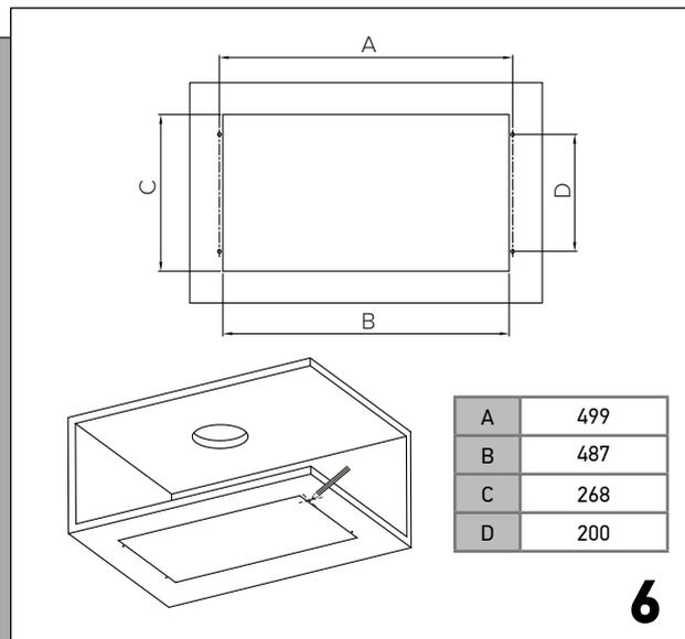
Подготовьте разметку в месте крепления вытяжки в шкаф, опираясь на ее внешние размеры.
