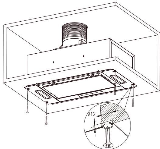
Установите вытяжку в кухонный шкаф, используя имеющийся крепеж. Надежно закрутите саморезы.
