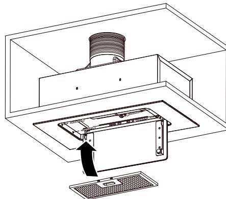
Смонтируйте нижнюю панель вытяжки, используя ранее выкрученные 4 винта.
