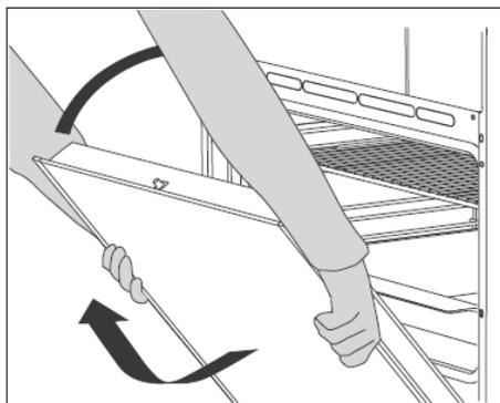
Для установки дверцы выполните описанные действия в обратном порядке, держа дверь по бокам обеими руками ближе к нижней части двери, установите петли в отверстия передней рамки духового шкафа. Полностью открыв дверь, снимите два металлических стержня с петель. Медленно закройте дверь. Убедитесь, что она установлена правильно и ровно относительно боковых сторон.
