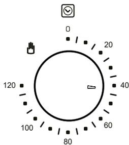
1. Поверните диск таймера на нужную настройку.
