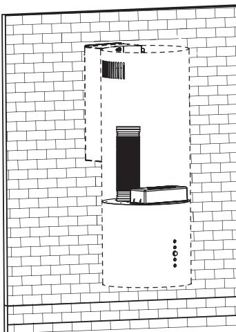
4. Соедините воздуховодной трубой выпускное отверстие кухонной вытяжки и вентиляционное отверстие.
