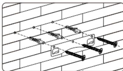
Просверлите **3 отверстия**. Установите крепление на стене, используя соответствующие винты и дюбели.
