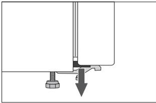
На углах дверей установлены распорки. Снимите распорки и на их место вставьте заглушки, которые прилагаются в комплекте (в некоторых моделях).
