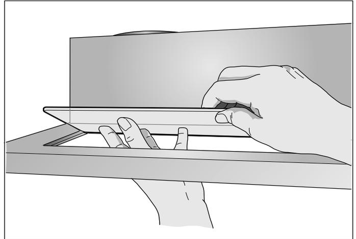
**Установка металлического жироулавливающего фильтра**
