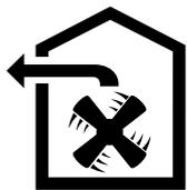
Втянутый воздух очищается жировлавливающим фильтром и подаётся по системе труб наружу.
