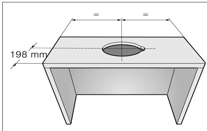
2. При наличии нижней полки снимите её. Обозначьте точки крепления на внутренних сторонах шкафа и предварительно прорежьте резцом. Для обозначения точек крепления используйте прилагаемую крепёжную деталь.
