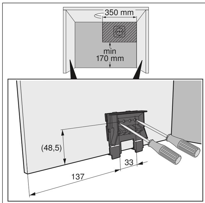
**Толщина стенок корпуса: 16 мм**
