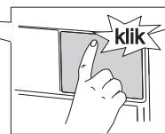
**1** Нажмите на крышку, где показывает наклейка, чтобы открыть крышку. Затем наклейку можно снять.
