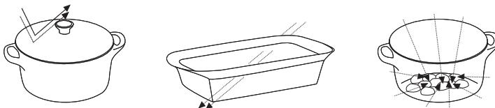
Под воздействием микроволн молекулы начинают двигаться с большой скоростью, создавая молекулярное трение, которое и приводит к нагреванию продукта.
