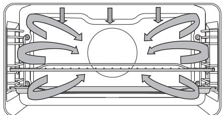
Одновременно работают верхний нагревательный элемент, инфранагреватель и нагревательный элемент вокруг вентилятора. Используется для приготовления всех видов мяса.
