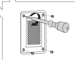
**1** Открутите четыре винта на крышке. Снимите крышку и стекло.
