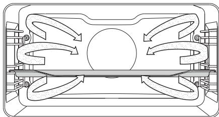
Парогенератор подает в рабочую камеру пар. Одновременно с паром работают нагревательный элемент вокруг вентилятора и вентилятор, который обеспечивает циркуляцию горячего воздуха и пара.
