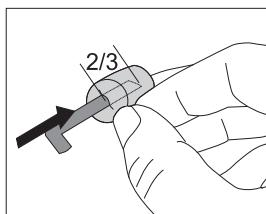
Если фильтр снимается с трубы, поместите его обратно, надев на трубку на 2/3 от его длины.
