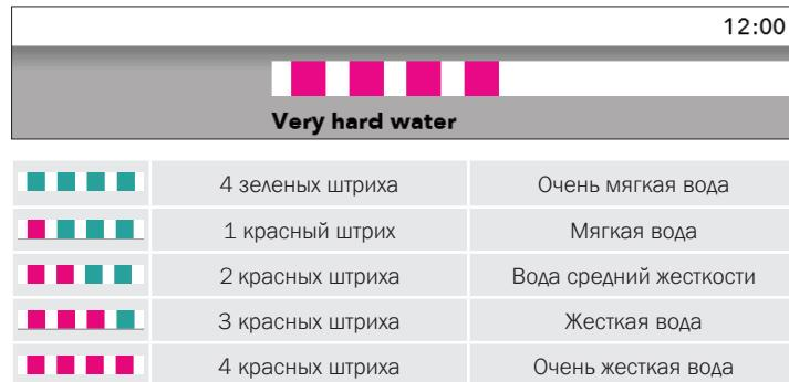
Опустите тест-полоску (прилагается в комплекте) в воду на 1 секунду. Через одну минуту введите результат (количество штрихов на тест-полоске) в прибор. Поверните ПЕРЕКЛЮЧАТЕЛЬ.
