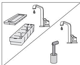
**3** Промойте трубку подачи воды с фильтром под проточной водой. Проследите, чтобы в материале фильтра не осталось загрязнений. Таким образом вы обеспечите исправную работу прибора и сохраните свежий вкус и аромат пищи.
