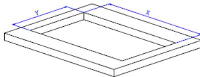
Данный прибор должен быть встроен в шкаф кухонного гарнитура или столешницу толщиной 300 мм, при этом должны быть соблюдены требования в отношении минимальных расстояний:
